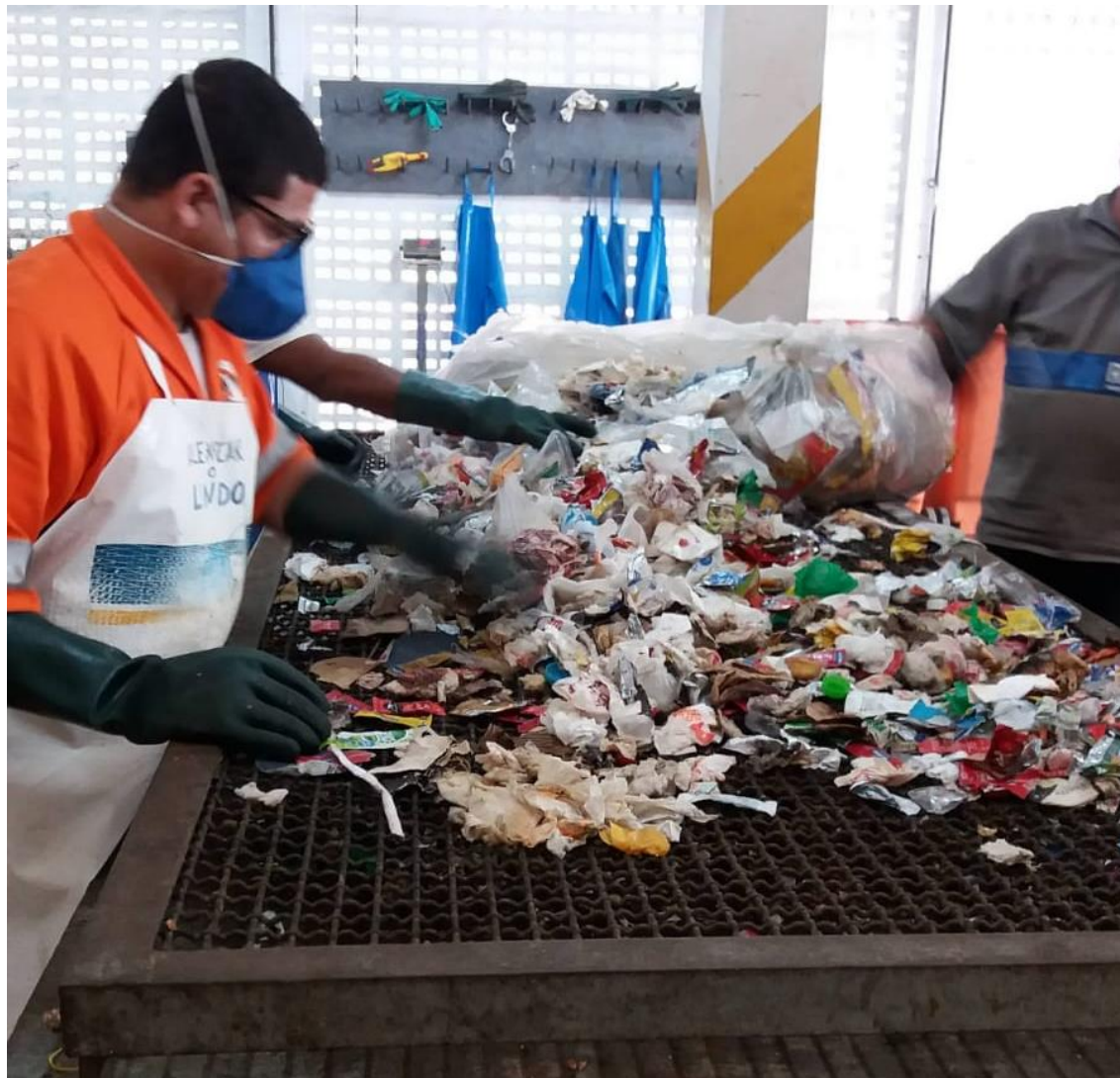
Figura 1 Laboratório de caracterização gravimétrica. Mesa de separação de resíduos.
