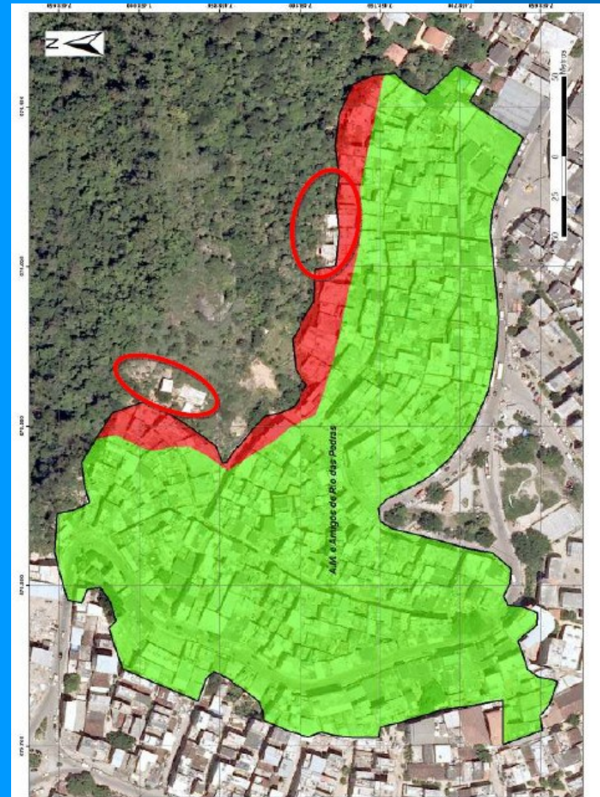
FIGURA 3- IDENTIFICAÇÃO E LOCALIZAÇÃO DOS SETORES DE RISCOS A ESCORREGAMENTOS. EM VERDE BAIXO RISCO, EM VERMELHO ALTO RISCO E EM ESTAQUE, ÁREAS DE EXPANSÃO DA FAVELA, DENTRO DO SETOR DE ALTO RISCO.
