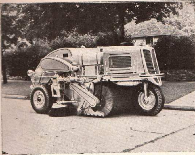
Auto-varredor Elgin — A direcção á direita permite uma visão completa do motorista no momento de estacionar
