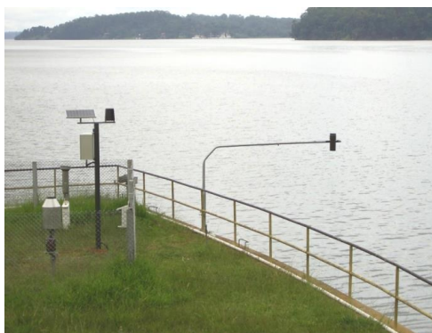
Figura 7.8 – Medidor de Nível por Ultra-Som
