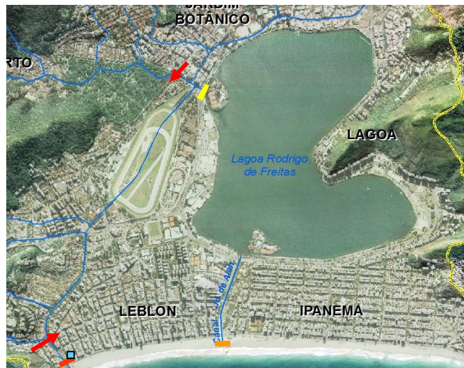
Figura 6.3 - Tempo Seco - Não há entrada de água pelo canal da Rua Gen. Garzon. Água segue para a Elev. da Visconde de Albuquerque
