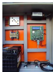
Figura 7.9 – Medidor de Nível por Pressão Hidrostática
