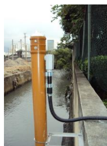
Figura 7.9 – Medidor de Nível por Pressão Hidrostática
