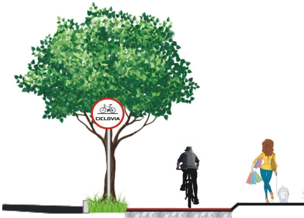
Figura 57 - Desenho esquemático de ciclovia com todos os elementos adjacentes presentes: terrapleno, via adjacente, sinalização, etc. Fonte: “Caderno de Referência para Elaboração de um Plano de Mobilidade por Bicicleta nas Cidades” – Ministério das Cidades, Brasília, 2007.
