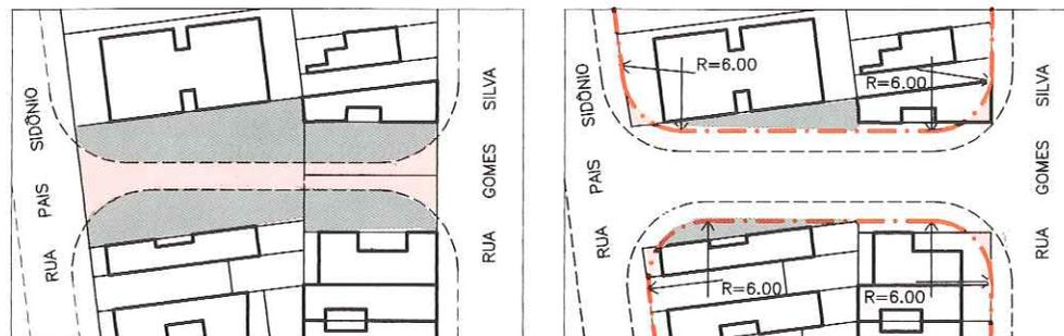
PA retificando o traçado da via, em função da caixa de rua já existente.
