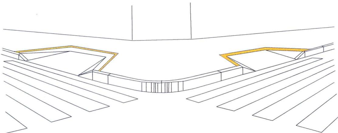
Nas calçadas estreitas as rampas devem ser construídas longitudinalmente, na largura total da calçada:
