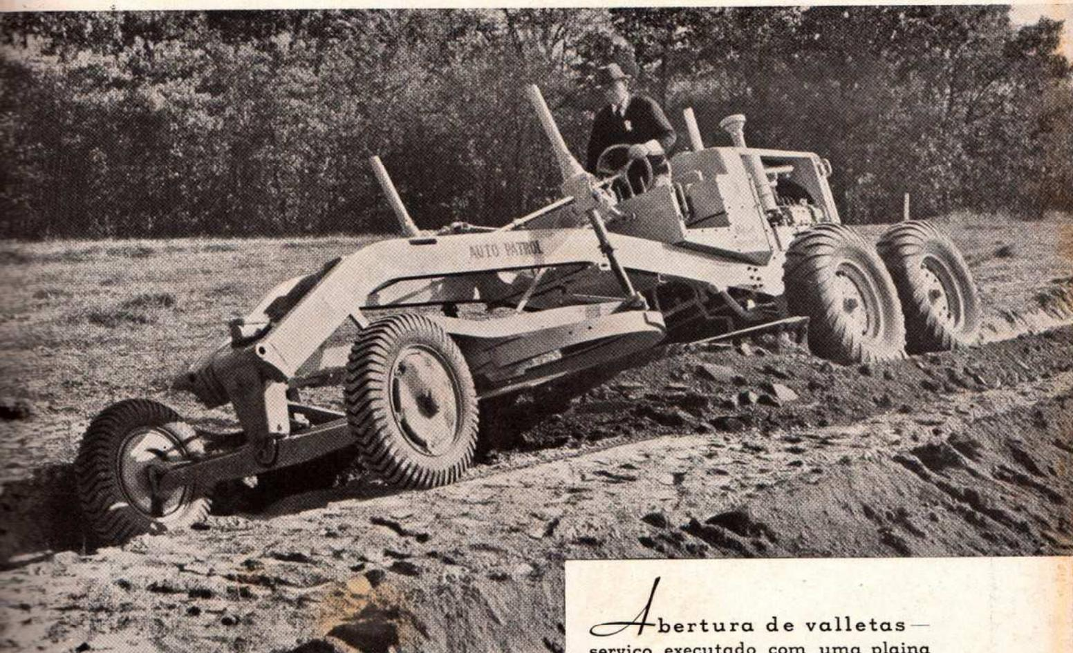
*A*bertura de valletas — serviço executado com uma plaina auto-motora DIESEL n.º 11 typo "tandem", — um expoente do aperfeiçoamento alcançado pela engenharia mecânica.
