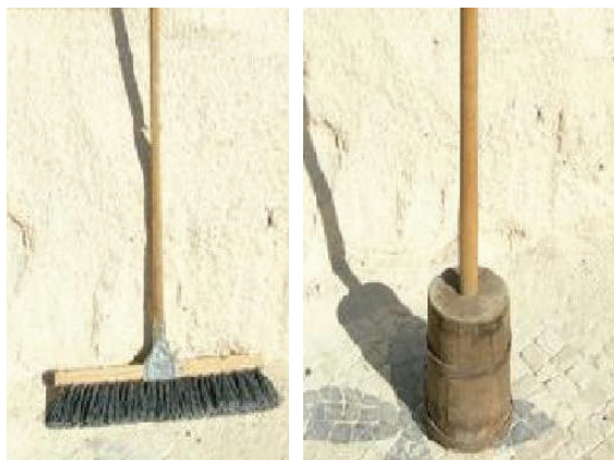
Ferramentas de calcetar - martelo, vassoura e soquete ou malho
