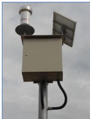
Figura 8-3 – Pluviômetro utilizado na Estação Telemétrica (PN).
