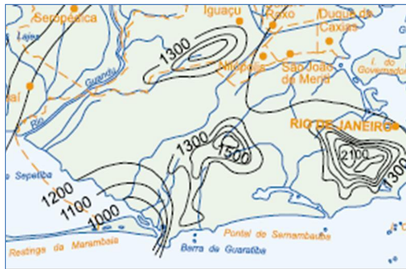
Figura 1-2 – Configuração isoietal das chuvas máximas de 24 horas.
