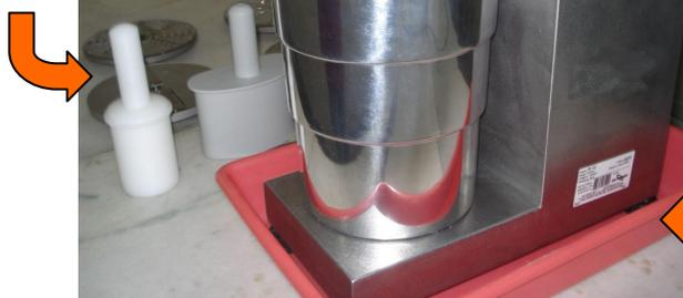
Colocar o processador dentro de um recipiente plástico, para conter os resíduos que são produzidos durante o uso do equipamento.
