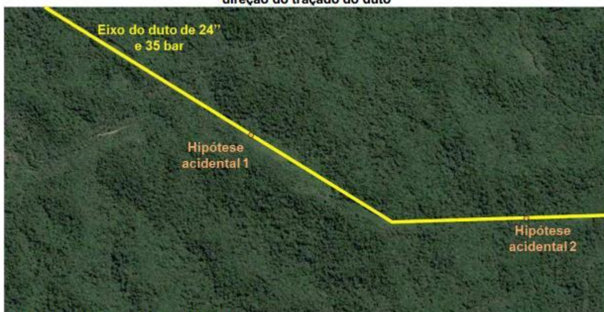
Figura 11 – Exemplo de formulação de duas hipóteses acidentais devido à mudança na direção do traçado do duto
