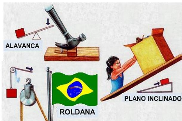
Máquinas simples modificam e transmitem a ação de uma força para realizar algum **movimento**. São máquinas que facilitam a atividade humana, simplesmente por nos permitir realizar uma tarefa com **menor esforço físico**. Uma tesoura ou um simples parafuso são considerados máquinas.
