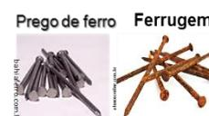
Um prego de ferro ou uma palha de aço, expostos ao sol e à chuva, irão enferrujar, isto é, reagirão com o gás oxigênio do ar e se transformarão em ferrugem.
