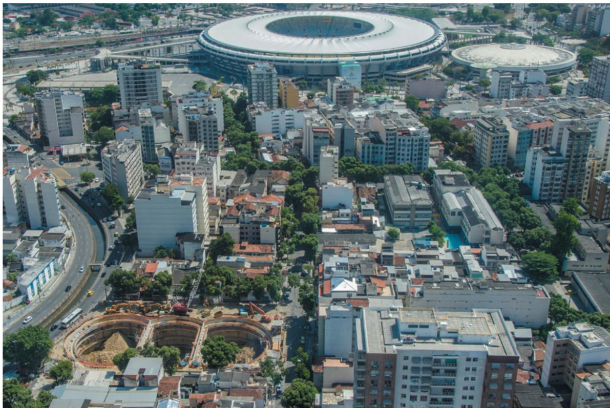
No canto inferior esquerdo, o reservatório subterrâneo da Praça Niterói em construção, com capacidade para 75 milhões de litros, parte da obra de drenagem da região da Grande Tijuca.
