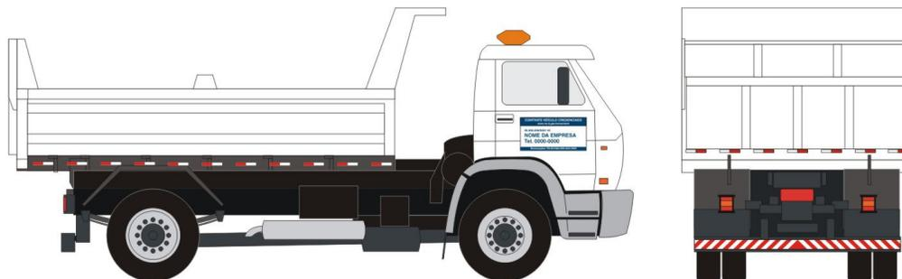
C.06 Os veículos e os equipamentos, com exceção dos bags e dos contêineres semi-enterrados, devem ter, em todo seu perímetro, uma faixa com, no mínimo, 5 (cinco) centímetros de largura, fabricada em material refletivo ou pintada com tinta refletiva, para efeito de sinalização noturna.
